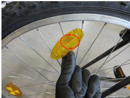
3. Schieben Sie den Reflektor soweit Richtung Radachse bis beide Speichenstreben vollständig hinter den Klemmnasen des Reflektors eingerastet sind
