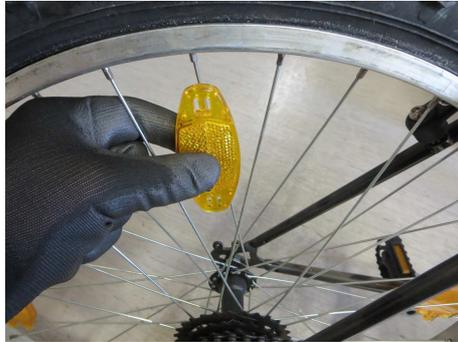
2. Verdrehen Sie nun den Reflektor um 90° nach rechts oder links. Achten Sie darauf, dass sich die Speichenstreben links und rechts in die Führungsnut des Reflektors schieben.
